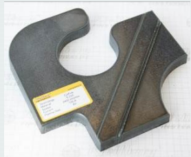
Leikkaus- ja merkkusmalli 10 mm rakenneteräs
